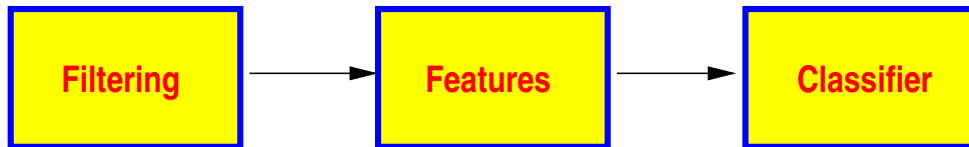
Abbildung 1: Aufbau eines Mustererkennungssystems
